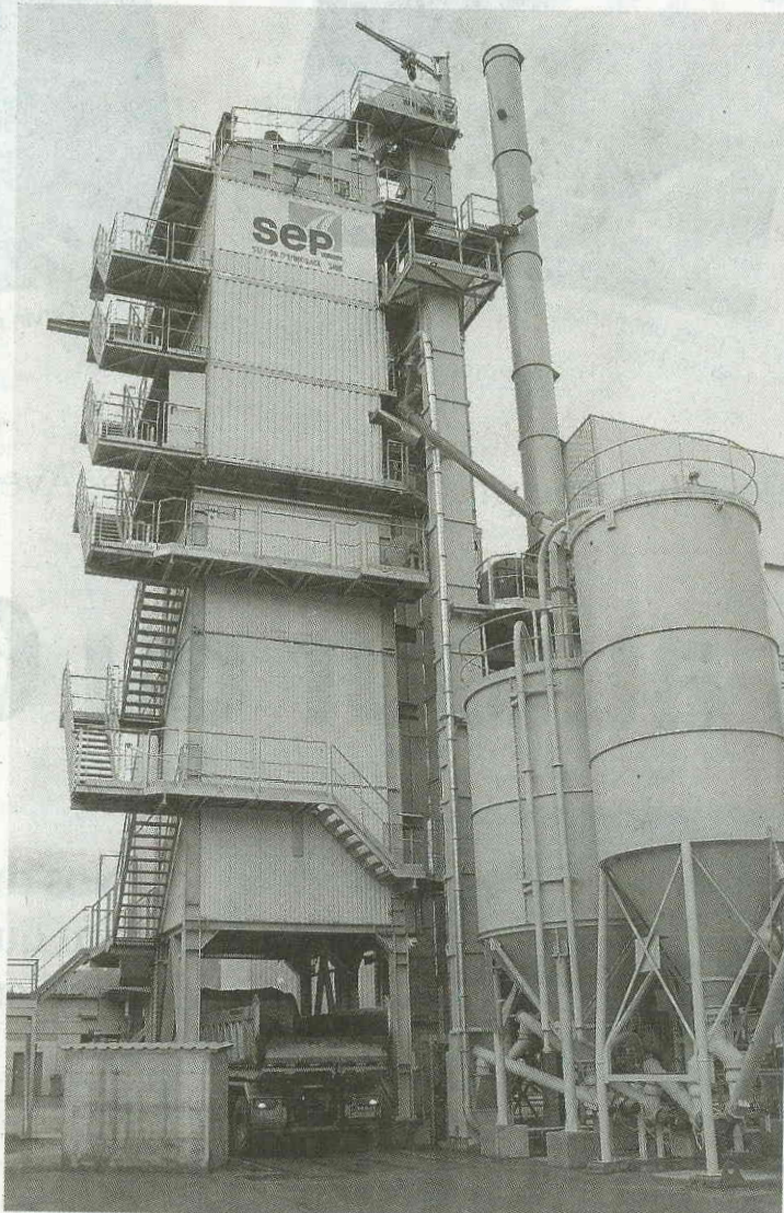
Une imposante tour de 33 mètres de haut nécessaire pour produire de l'enrobé bitumineux le plus écologique possible. LE NOUVELLISTE
